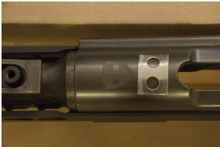
5. Placez le rail par-dessus l'écrou (et par-dessus la plaquette de pente, si il y en a une), et engagez la pièce dans le porte-hausse, de manière que les trous goupille du rail et du porte-hausse correspondent. Remettez la goupille.
